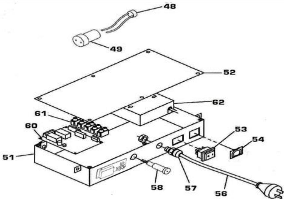
Таблица А1 – Перечень деталей к внешнему виду дизельного теплогенератора
