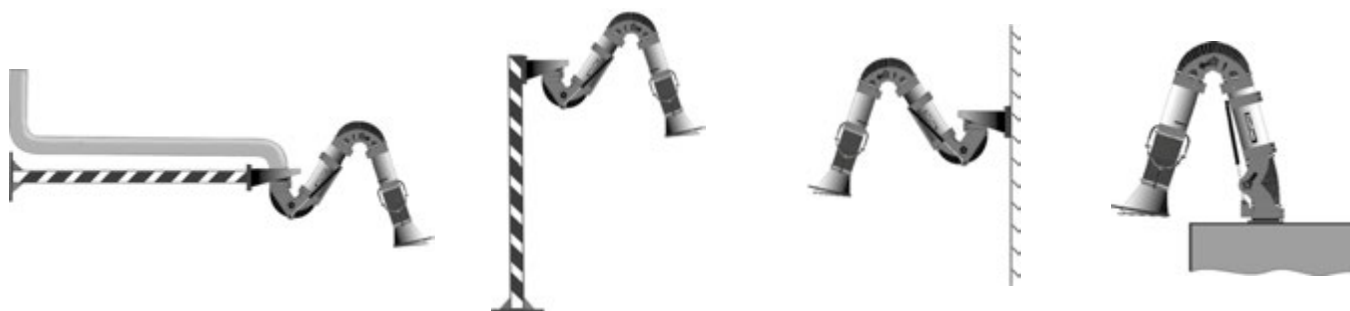
1. На стене с помощью балки-стойки PA-110, PA-220
