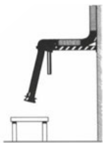
2. На стене, на опоре РА-110, РА-220;
