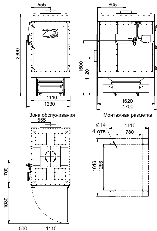
MDV-6L (для фильтра MDV-6R) расположение ВМО и контроллера зеркально
